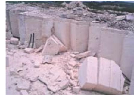
Dans les bancs de calcarénites de Petite Butte, des carrières (improprement appelées localement « carrières de corail »), exploitées jusqu'en 2002, ont permis l'extraction de blocs destinés à la construction d'habitations.
